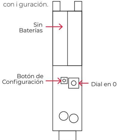
**3.3. Coloque las baterías y suelte el botón de configuración,** el sensor responderá con pitidos:
