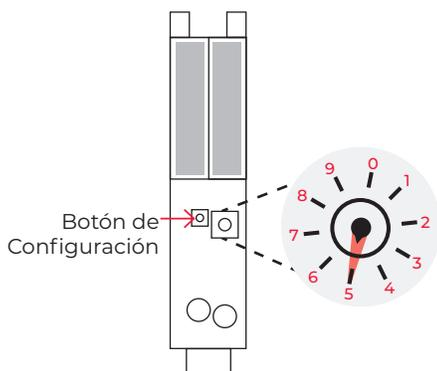
**5.2.** Coloque el dial en el **número 0** y, con su control remoto previamente posicionado en el canal donde está el motor que deseamos configurar al sensor, presione: **P2, P2**, y en su sensor presione el **botón de configuración 1 vez**.
